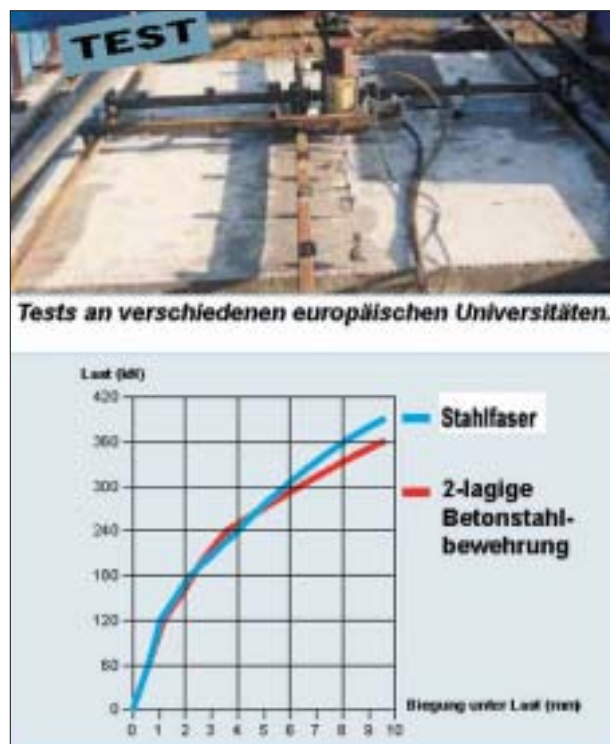
Bild 3: Faserbeton contra Stahlbeton gemäß /3/
